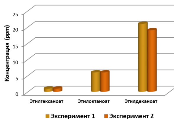
Концентрация основных эфиров в 2 экспериментах с DistilaMax RM
