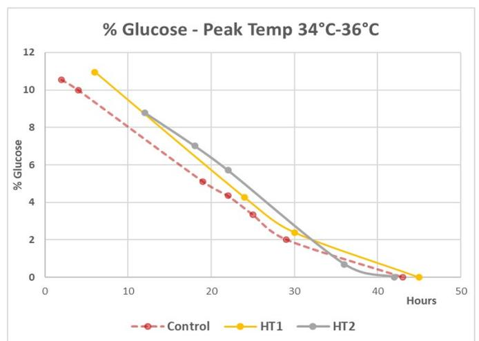
**Figure 2: Teneur en glucose (%) durant la fermentation avec DistilaMax HT.** Essai, États-Unis 2019
