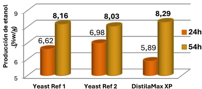
Figura 1: Resultados del contenido de etanol (%w/v) tras 24h y 50h en cebada malteada, densidad inicial 1077.
