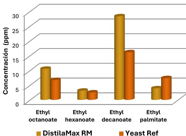
**Concentración de ésteres aromáticos clave en 2 ensayos con DistilaMax RM**
